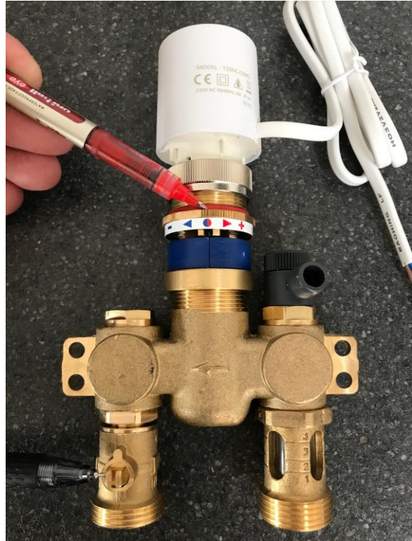
Typisk indstilling på ventil i skakt
